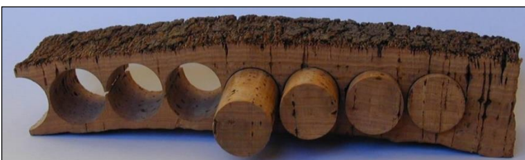
Bande de liège « tubée » pour la fabrication de bouchons en liège naturel (photo : IML).
